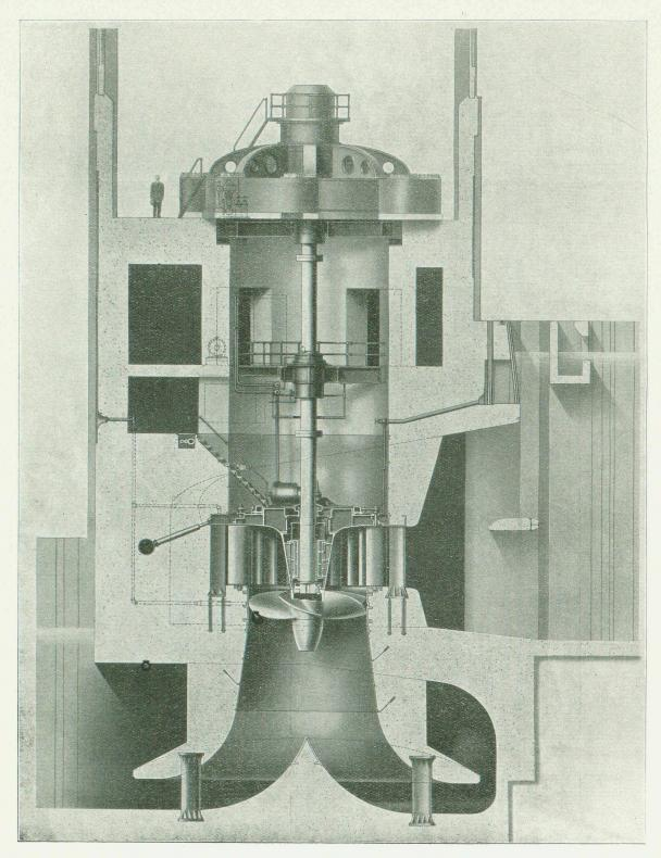
Fig. 4. — Usine de Louisville, sur l'Ohio. Hydrocône White évacuant la décharge d'une turbine-hélice à 5 pales en acier moulé. (Allis Chalmers Mfg. C°, Milwaukee.)
