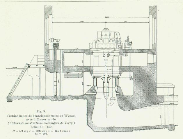
Bronner 1. Malheureusement, le coude Kaplan nécessite une excavation plus profonde et plus large, d'où la préférence donnée souvent aux profils arrondis. Les diffuseurs coudés étant impuissants à réduire la composante tan-
