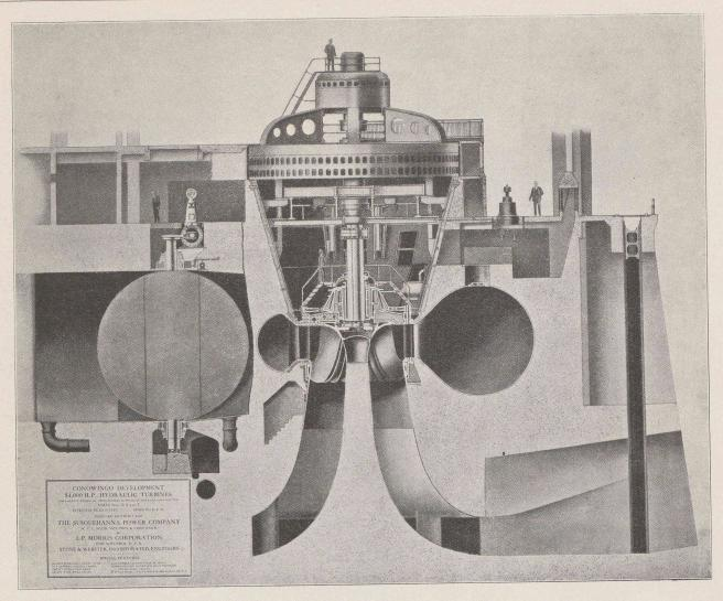
Fig. 3. — «Spreading Draft Tube» Moody d'une des 7 turbines de l'usine de Conowingo, sur le Susquehanna. — ( $I.\,P.\,Morris\,Corporation$ , Philadelphie.)  $H=27\,\mathrm{m}$ ;  $P=54\,000\,\mathrm{HP}$ ;  $n=82\,\mathrm{t}$ : min.
