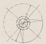
Fig. 6. — Déviation du coude *Kaplan* par ablation d'un secteur du diffuseur circulaire.
