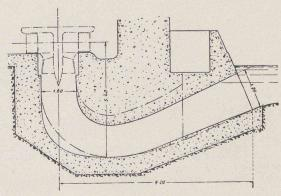
Fig. 8. — Diffuseur coudé, systême Bell (Kriens). H=3,45 m; P=310 ch; n=200 t: min; ns=750.
