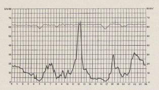
Fig. 1. — Action régulatrice des cuisinières à accumulation sur la courbe de charge totale d'un réseau communal ne desservant pas d'industrie.
