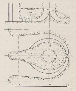
Fig. 2. — Hydrocône *Moody* d'une turbine de 37 500 HP.
