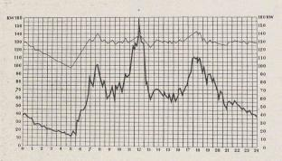
Fig. 2. — Action régulatrice des cuisinières à accumulation sur la courbe de charge totale d'un réseau communal desservant une population faiblement industrielle.
