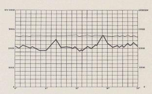
Fig. 3. — Action régulatrice des cuisinières à accumulation sur la courbe de charge totale d'une usine génératrice dotée d'un bassin d'accumulation saisonnier.
