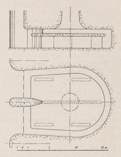
Fig. 1. — Hydrocône White d'une turbine de 37 500 HP.
