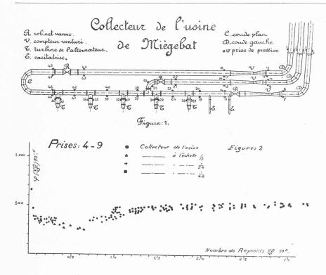
valeurs du nombre de Reynolds comprises entre 1×106 et 3×106 (fig. 2). L'extension de cette notion d'ouvrages courts à des ouvrages industriels mettant en jeu les dimensions et les vitesses couramment utilisées dans les usines hydrauliques constitue un point particulièrement intéressant.
