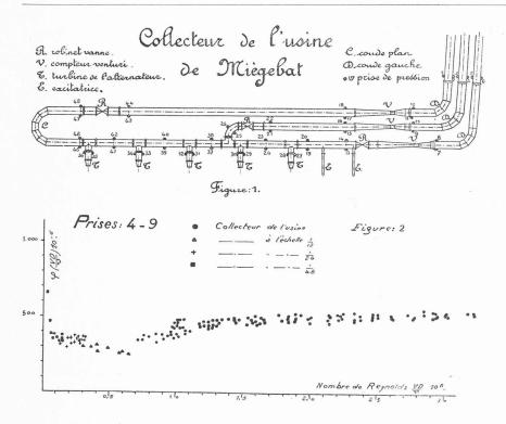
valeurs du nombre de Reynolds comprises entre  $1 \times 10^6$  et  $3 \times 10^6$  (fig. 2). L'extension de cette notion d'ouvrages courts à des ouvrages industriels mettant en jeu les dimensions et les vitesses couramment utilisées dans les usines hydrauliques constitue un point particulièrement intéressant.
