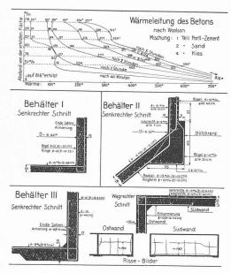
Fig. 12. — Essais sur la conductibilité thermique du béton.
