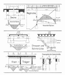
Fig. 8. - Encastrement de divers ouvrages.
