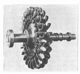
Fig. 9. - Roue Pelton à faible ns.
