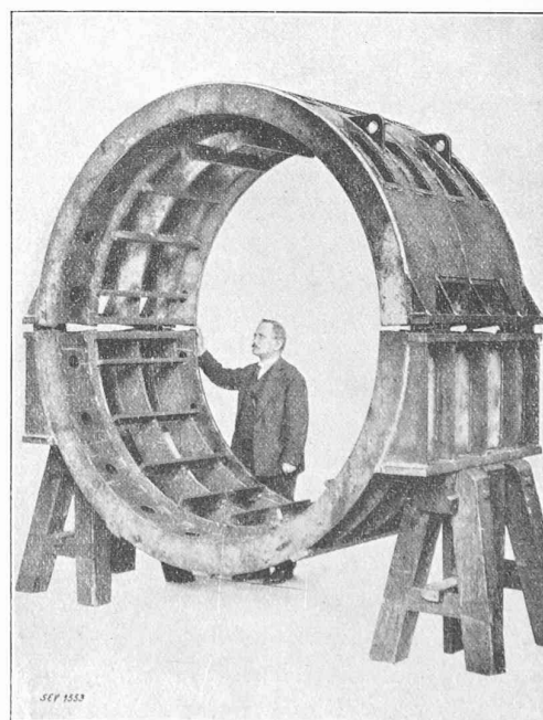
Fig. 17. — Carcasse d'un alternateur de 3800 kVA, Ateliers de Sécheron.
