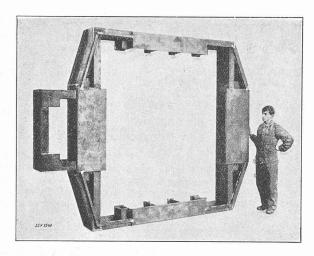
Fig. 11. — Plaque de base d'un alternateur triphasé, S. A. des Ateliers de Sécheron.
