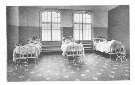
Fig. 4. Chauffage d'une salle de 6 lits par 4 radiateurs de 1,5 kW placés sous les fenêtres.
