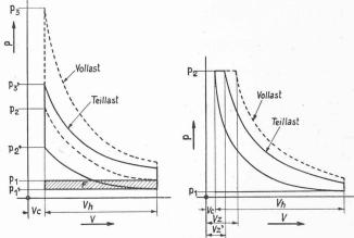
Fig. 23. — Diagramme de réglage par étranglement du courant d'air d'un moteur à explosion (mélange de combustible et d'air).
