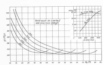
Fig. 22. — Puissance et consommation de combustible, en fonction de la charge et de la vitesse angulaire, d'un moteur Saurer-Diesel à 6 cylindres, type BLD.
