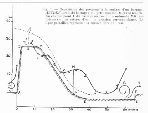
le déversement de crues, pouvant atteindre 3500 m³:s, sur un barrage de 25 m de hauteur, que l'on construit, sur le Tarn, à Pinet.
