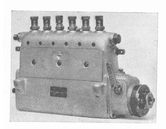
Fig. 18. — Vue de la pompe à combustible Bosch.
