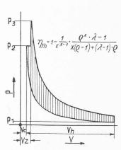
Fig. 7. — Explosion retardée, précédée d'une combustion à pression constante.
