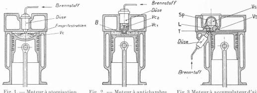
Fig. 1. — Moteur à atomisation. Vc = 100 %, immédiatement au-dessus du cylindre moteur
