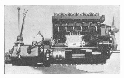
Fig. 10. — Vue longitudinale, de droite, du moteur Saurer-Diesel à 6 cylindres, type BLD avec boîte des vitesses montée, pompe à combustible avec ses conduites de distribution, injecteurs, démarreur, commande de la pompe centrifuge, pédale de débrayage, levier du frein à main et levier des vitesses, pompe pour le gonflement des pneus.
