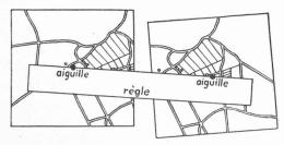
Fig. 3. Orientation relative de l'aérostéréogramme.
