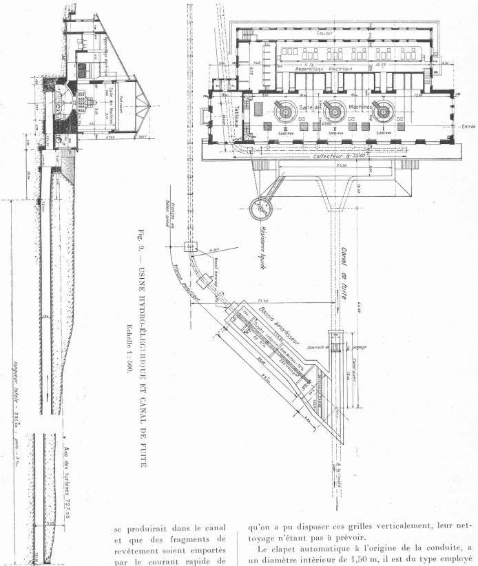
rées, passent librement entre les barreaux des grilles et ne peuvent en aucune façon gêner le fonctionnement des turbines. C'est pour cela
