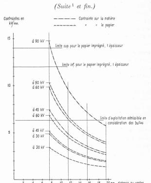
Fig. 1. — Contraintes sur papier imprégné et ma ière de même épaisseur dans un câble.
