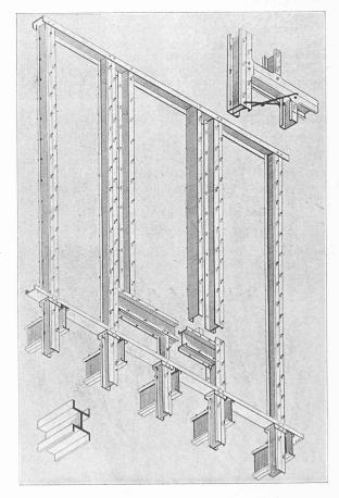
Fig. 18. — Ossature de cloison composée de profilés en tôle.
