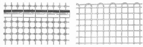
Fig. 11 et 12. — Lattis métalliques constitués par des fils.
