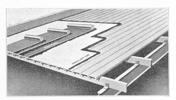
Fig. 19. Schéma des éléments constitutifs de la couverture à ossature en «feuille de toit».
