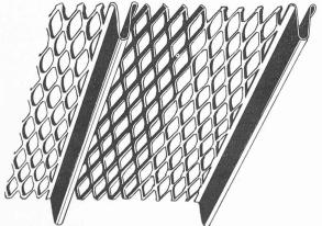
Fig. 13. - Lattis avec nervures ou «ribs».
