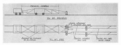
Fig. 1. — Schéma de fonctionnement d'une ripeuse de voie.
