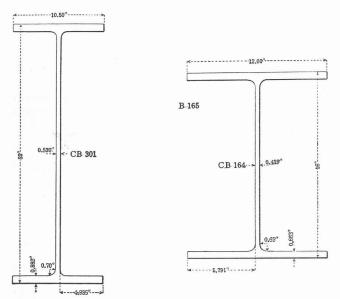
Fig. 7. — I-beam, fabriquée par la Carnegie Steel C°, correspondant au nombre-combinaison 301.
