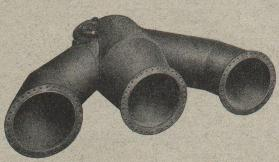
Culotte assemblée exclusivement par soudure à l'arc électrique.
