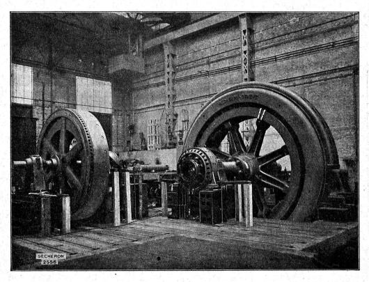
Ateliers de Sécheron. — Stand d'essai des machines tournantes.
