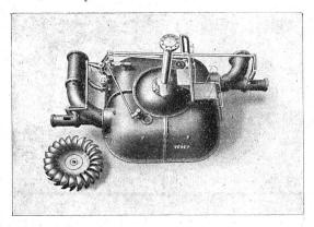
Une des turbines de l'Usine de Sembrancher (Société romande d'électricité). Axe vertical. - 2 injecteurs. - 5300 ch sous 156 m de chute.
