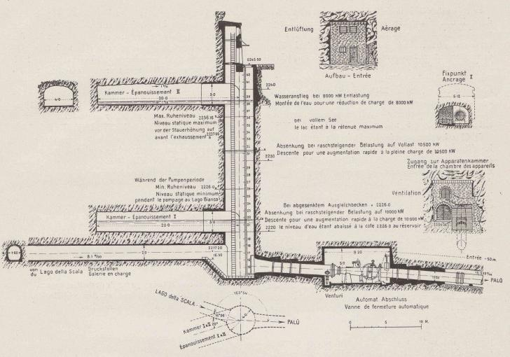
Fig. 3. — Usine de Palü. — Cheminée d'équilibre et chambre des appareils.
