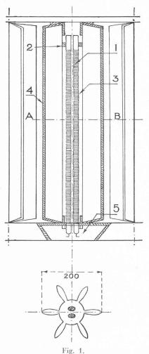
Calorifère électrique à chauffage direct. Elévation-coupe et plan d'un élément.
