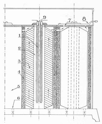
Fig. 2. — Calorifère électrique à accumulation. Elévation et coupe.
