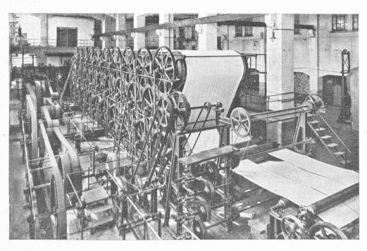
Fig. 6. — Séchage de la cellulose en feuilles.
