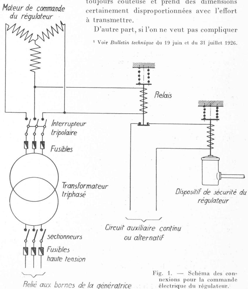
Fig. 1. — Schéma des connexions pour la commande électrique du régulateur.
