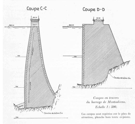
à proprement parler en arc; la région inférieure, très épaisse dans le sens de l'axe, totalement encastrée, coincée pour ainsi dire dans le roc, forme un socle absolument rigide.
