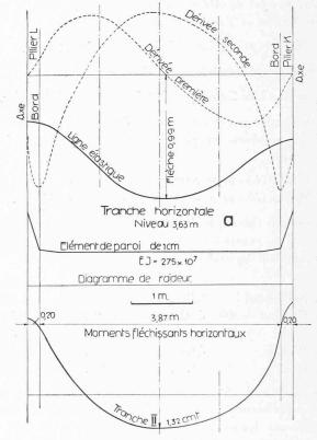
Fig. 23 à 25. Dérivation de la ligne élastique horizontale constatée.
