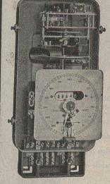
Compteur avec indicateur de maximum et contact à signaux
