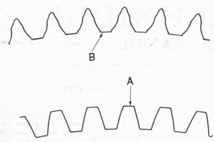
Fig. 14. — Profil des dents de deux roues d'engrenage appartenant au même véhicule et ayant accompli le même trajet. Le carter de la roue A était étanche, contrairement à celui de la roue B.
