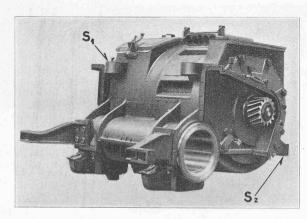
Fig. 15. — Moteur de 340 ch des locomotives Bo-Bo des chemins de fer autrichiens.  $S_1$  et  $S_2$ : points de suspension.
