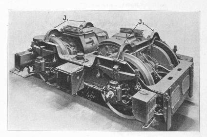
Fig. 16. — Bogie d'une locomotive Bo-Bo des chemins de fer autrichiens avec deux moteurs de 340 ch et leurs jougs de suspension  $J_1$  et  $J_2$ .
