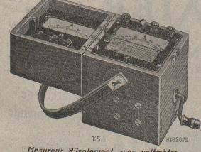
Mesureur d'isolement avec voltmètre.
