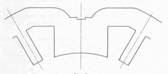
Fig. 7. Secteur de tôle de stator d'un moteur monophasé non compensé.
