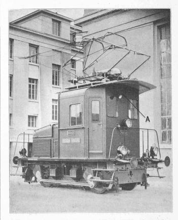
Fig. 10. — Locomotive de manœuvre des CFF., type  $Ee\ 2/2$ . A= prise d'air.
