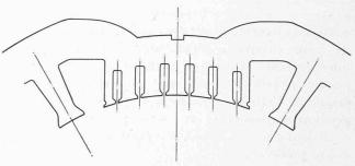
Fig. 8. — Secteur de tôle de stator d'un moteur monophasé compensé, montrant les encoches destinées à recevoir l'enroulement de compensation.
