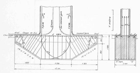
Fig. 5. — Détails de fondements. Piliers et parois. — 1:50.
