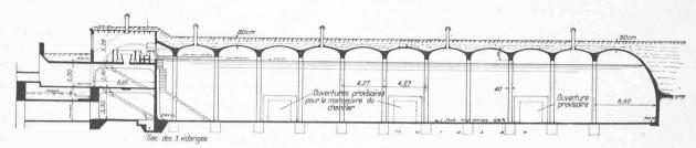
Fig. 1. — Coupe en long suivant l'axe du réservoir (Chambre médiane). — 1:400.
