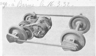
Fig. 4. — Transmission par double train d'engrenages, des locomotives de manœuvre des C. F. F., type Ee 2/2.
