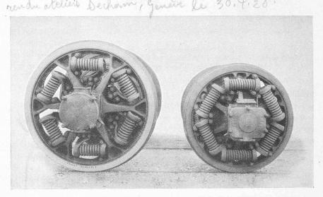
Fig. 2. — Accouplements élastiques système Westinghouse (à gauche) et système Sécheron (à droite).
