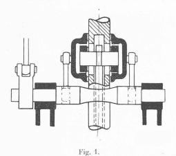
Arbre intermédiaire commandant le pivotement des pales de turbines *Kaplan* dans le cas du régulateur à double servo-moteur.
