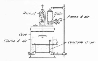
Fig. 4. — Détail du flotteur Voith commandé à distance.
