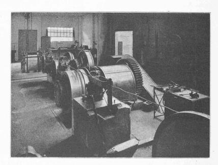
Fig. 2 — Machine à étirer le fil à trolley.
