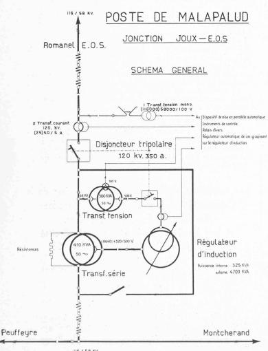
Fig. 14. — Schéma du poste de Malapalud.
