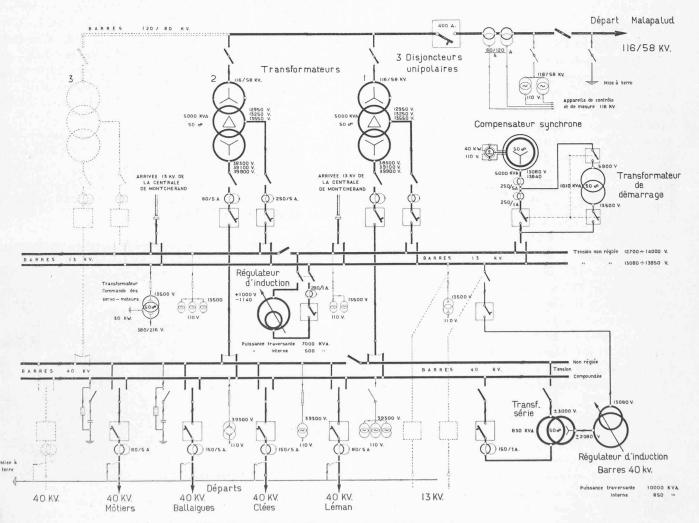
Fig. 7. — Poste de Montcherand. — Schéma général.
