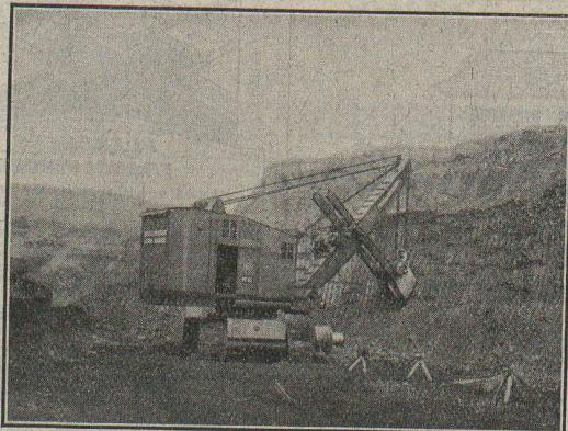
Cette pelle électrique sur chenilles avec godet de  $2 \text{ m}^3 \frac{1}{4}$  fait du déblai en donnant un rendement de **1400 m}^3 mesurés en place dans 9 h. et demi** travaillant à un front d'une hauteur d'environ 12 m. dans une matière consistant d'argile et de glaise dure avec une couche de grès d'une épaisseur d'environ 20 cm.
