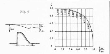
formule utilisée pour le calcul du débouché des déversoirs dénoyés est celle de Francis. Lorsque le déversoir est noyé, le coefficient d'écoulement est réduit suivant le degré de submersion. Pour un profil à crête arrondie, la variation de  $\nu$  est donnée sur le graphique ci-dessus¹, en fonction du quotient  $\frac{t_{av}}{t_{am}}$  (fig. 9).
