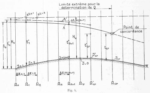
$t_0'$  a été fixée arbitrairement, on obtient du même coup une pente critique  $J_{cr}'$ , par suite la position de la section critique  $\Omega_{cr}'$  et le tirant critique  $t_{cr}'$  au droit de celle-ci (formule 18). Reportons dans les sections  $\Omega_0$  et  $\Omega_{cr}'$  les tirants  $t_0'$  et  $t_{cr}'$ . (fig. 4).
