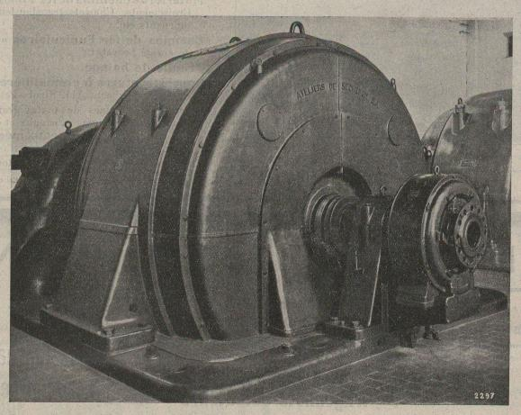
Alternateur monophasé 2400 KVA, 10000 V, 500 t.p.m., 162/3 pér/sec accouplé à une turbine hydraulique.
