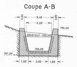
Fig. 14. — Bassin amortisseur de la conduite de décharge. Echelle 1 : 300.
