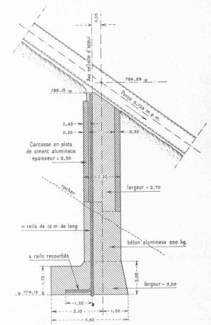
Fig. 12. — Massif géologique au piquet 7. Echelle 1: 150.
