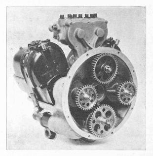
Fig. 4. — Couvercle arrière, côté pignons de commande.
