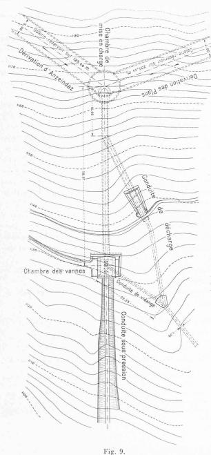
Plan de situation de la chambre de mise en charge.
