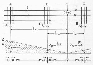
Fig. 1. — Court-circuit entre deux phases et variation de l'impédance de court-circuit.
