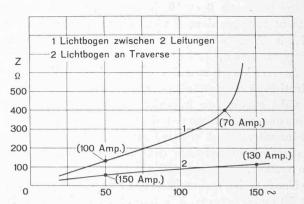
Fig. 2. — Résistance de l'arc de court-circuit sur un réseau de 110 kV, en fonction du temps (mesuré par la Bayenwerk A. G.):
