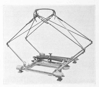
Fig. 13. — Prise de courant à pantographe.
