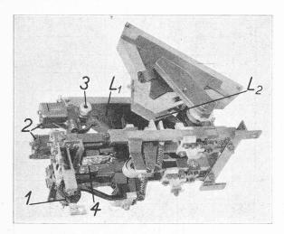
Fig. 7. — Interrupteur principal de la locomotive. Légende:  $L_1$ ,  $L_2$  = Contacteurs électro-pneumatiques. — 1 = relais à maxima de courant. — 2 = valve électro-pneumatique. — 3 = raccord d'air. — 4 = contacts de verrouillage.
