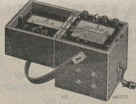
Mesureur d'isolement avec voltmètre.
