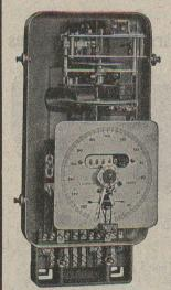
Compteur avec indicateur de maximum et contact à signaux SIMPLE - DOUBLE - TRIPLE TARIF
