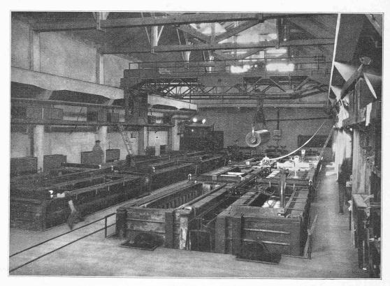
Fig. 1. — Atelier de fabrication électrolytique des planches de cuivre, à la Cie des produits électrochimiques, à Bex.
