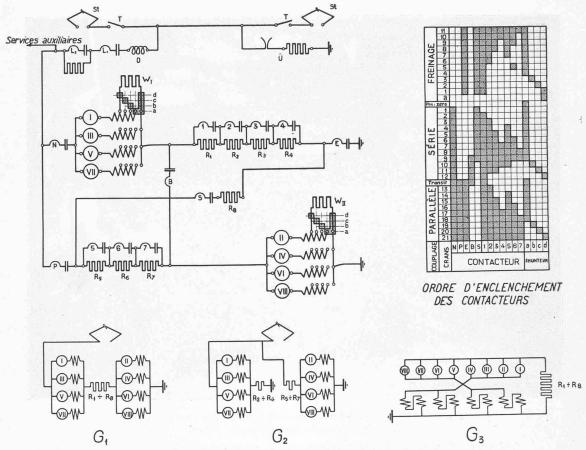
Fig. 4. — Schéma simplifié du circuit du courant principal.
