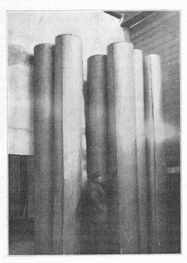
Fig. 3. — Feuilles de cuivre «Debex» détachées des cathodes.
