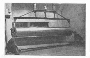
Fig. 2. — Démandrinage de la feuille de cuivre déposée sur un mandrin cathodique.
