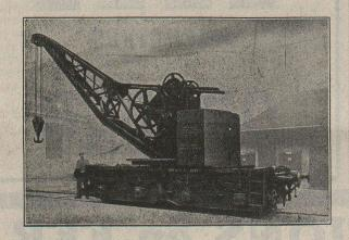
Grue pivotante, à commande à bras, à volée réglable et amovible et contrepoids à écartement fixe, sur vagon à 4 essieux.
