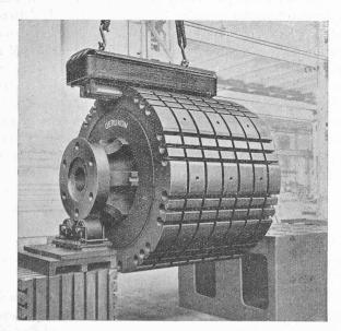
Fig. 27. — Fixation d'un noyau polaire sur le rotor d'un alternateur.
